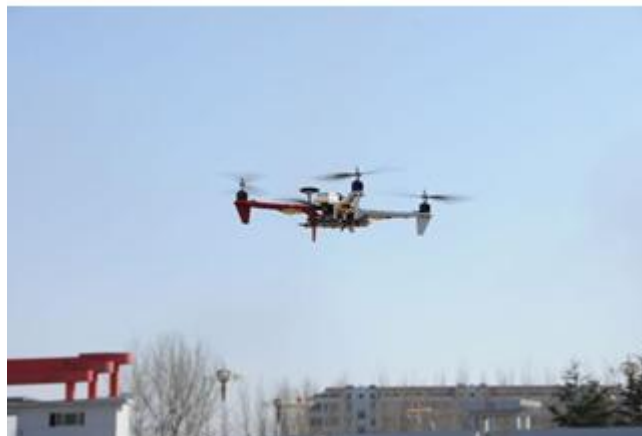
图 4-8 模拟竞赛作品：四轴无人飞行器
